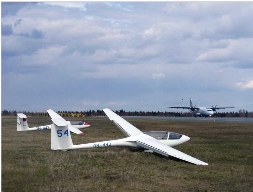
PIK-20 OH-442 Kemissä 24.5.2008. Kuvassa näkyy hyvin laippojen asento laskuasennossa. Laput kääntyvät täydet 90-astetta (Kuva: Juha Orasvuo)
