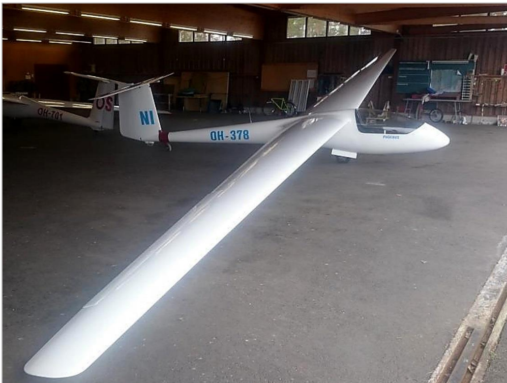
Phöbus C OH-378 nykykuosissa. Kuvasta näkyy avoimen luokan koneen pitkä kärkiväli – Phöbus C:n kohdalla siipeä on 17 metriä ja koneen liitoluvuksi ilmoitettiin 42 (Kuva: myynti-ilmoitus)
